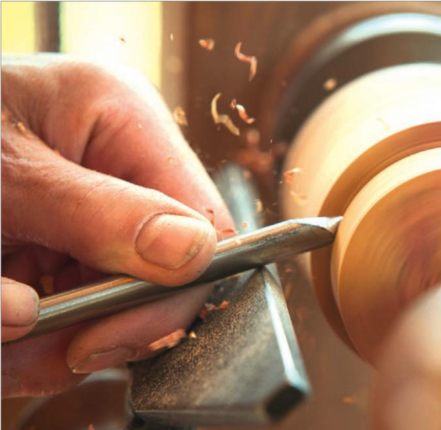
Mit Dreheisen wird an der Drehbank ein Werkstück in seine zukünftige Form gebracht.
