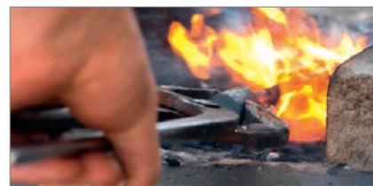
*Mit einer Zanke wird das Werkstück in das Feuer in der Esse gehalten, bis es glüht.*
