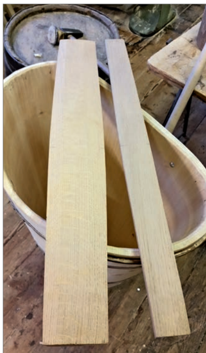
Fassdauben, im Verhältnis 1:6 zuge-schnitten (Fotos: Sylvia Rottensteiner)
