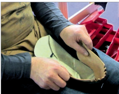
Afterleder für die Versteifung der Ferse
