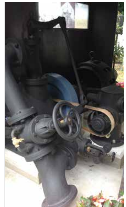
Die nach dem amerikanischen Ingenieur Lester Pelton benannte Turbine entsprach Ende des 19. Jahrhunderts höchsten technischen Standards.
